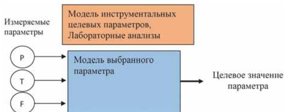
Рис. 3. Предиктивная система. Модель обрабатывает на входе измеряемые технологические данные и выдает целевые показатели
