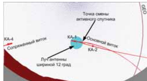
Рис. 4. Принцип работы системы «Экспресс-РВ»
