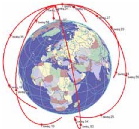
Рис. 16. Структура будущей орбитальной группировки системы «Гонец»
